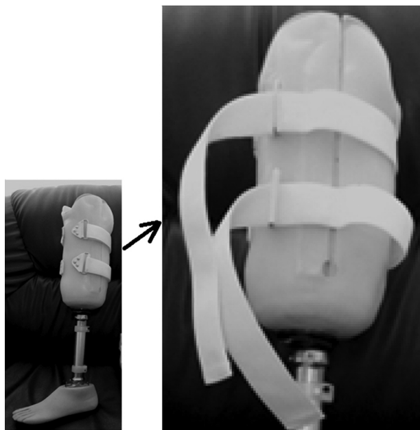
Рисунок Протез голени с регулируемой приёмной гильзой для левосторонних ампутационных дефектов Figure The above-knee prosthesis with adjustable sockets (models) for left-sided amputation defects
